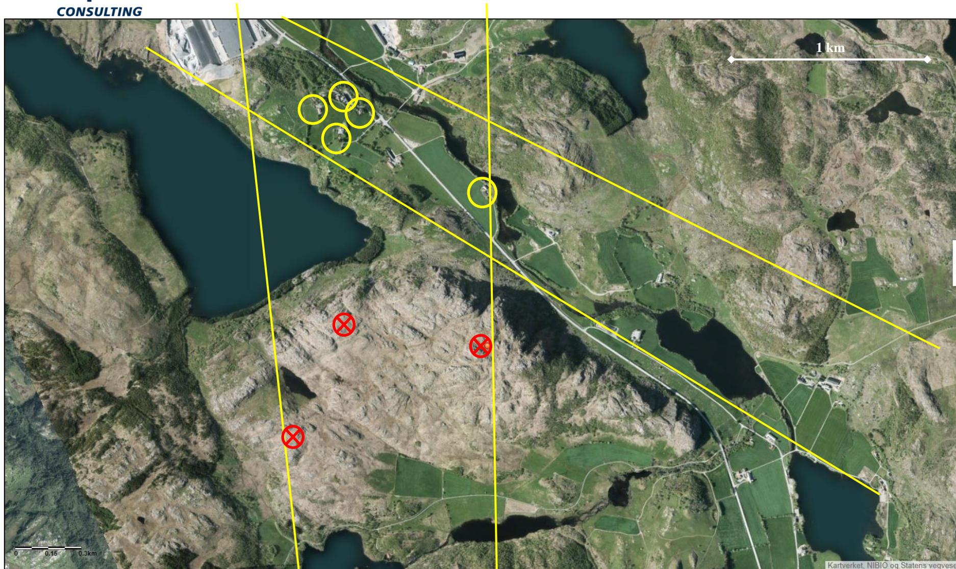
Figur 8. Fem bosetninger markert med gule sirkler i bildet kan teoretisk oppleve forstyrrelser på TV-signaler
