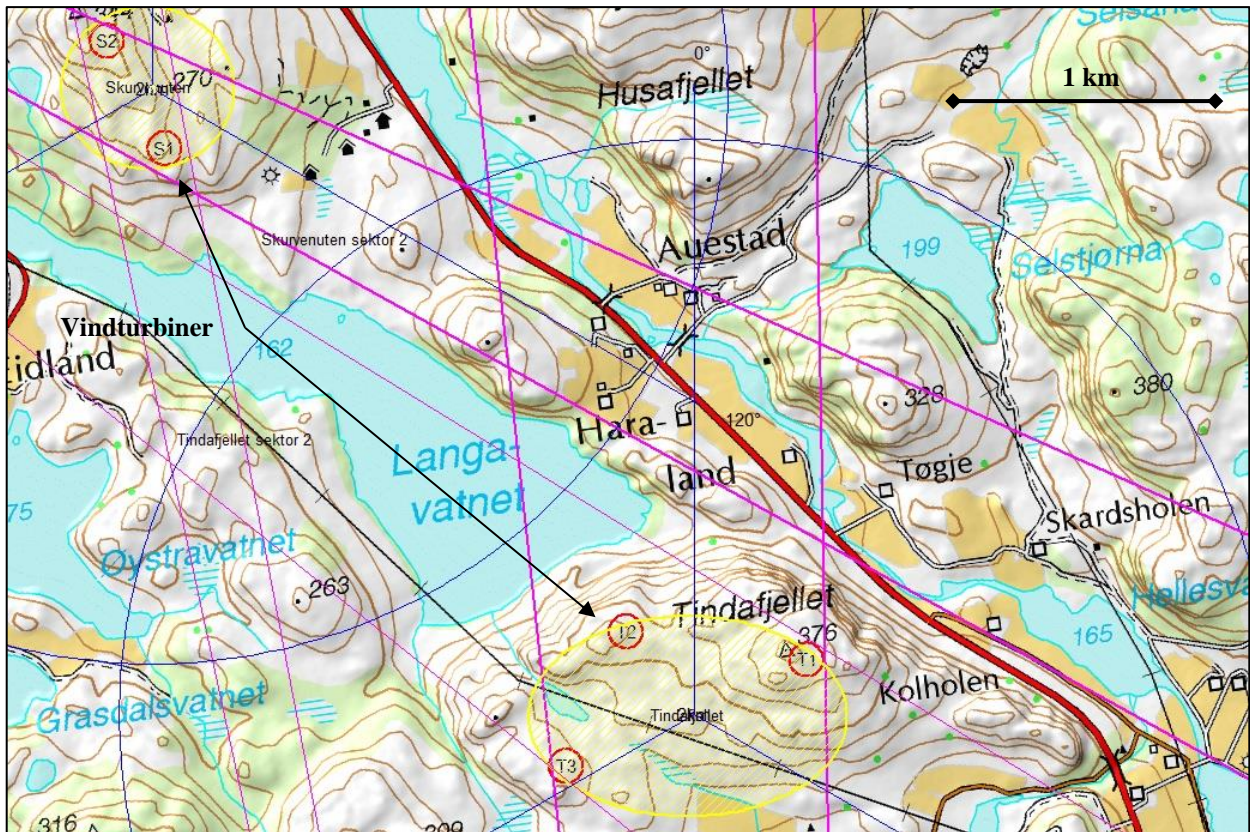
Figur 2. Siktlinjesektor fra TV-senderne mot Tindafjellet / Skurvenuten vindkraftverk (1:20 000)
